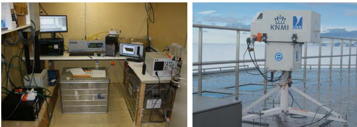
Figure 2.21. Gauche : instruments de mesure pour déterminer les propriétés physiques et optiques des aérosols. De gauche à droite : TEOM-FDMS (masse d'aérosol), aéthalomètre (absorption de lumière), néphélomètre (diffusion de lumière), spectromètre d'aérosol (taille des aérosols), compteur de particules (nombre d'aérosols); droite : spectrophotomètre à ozone Brewer sur le toit de la station.
